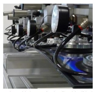
TPedge-Modul mit 2 mm-Dünnglas während der Flächenlastprüfung. ©Fraunhofer ISE
