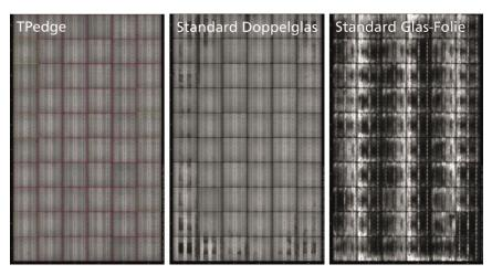
Elektrolumineszenz-Aufnahmen der geprüften Module nach 4000 Stunden Feuchte-Wärme-Prüfung (85 °C, 85% r.H.); TPedge-Modul (links), Glas-Glas-Laminat (Mitte), Glas-Folie-Laminat (rechts). ©Fraunhofer ISE
