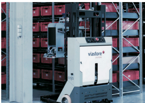
Automatischer Zugriff im Lager durch fahrerlose Regalbediengeräte: Der viarobot. (Quelle: viastore SYSTEMS GmbH)
