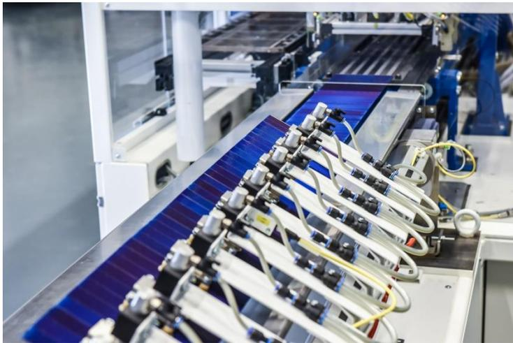
Elektrisch leitfähiges Kleben von geschindelten Zellen am industriellen Stringer im Module-TEC des Fraunhofer ISE. ©Fraunhofer ISE
