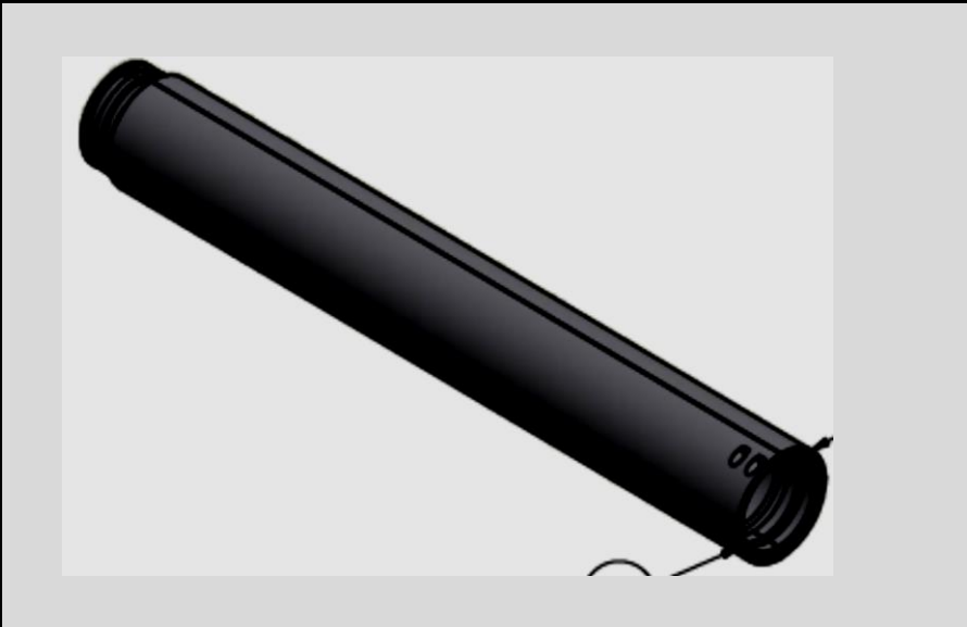
3D-Zeichnung geteiltes Bohrgestänge
