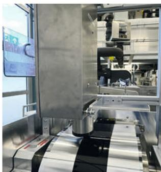
Abb. 2: In die Beschichtungsanlage integrierter konfokaler Sensor.
