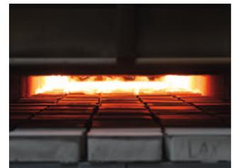
Abb. 3: Testbrand im Durchlaufofen bei 1180 °C.
