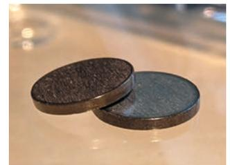
Abb. 3: KNN-Keramiken in Tablettenform zur elektrischen Charakterisierung.
