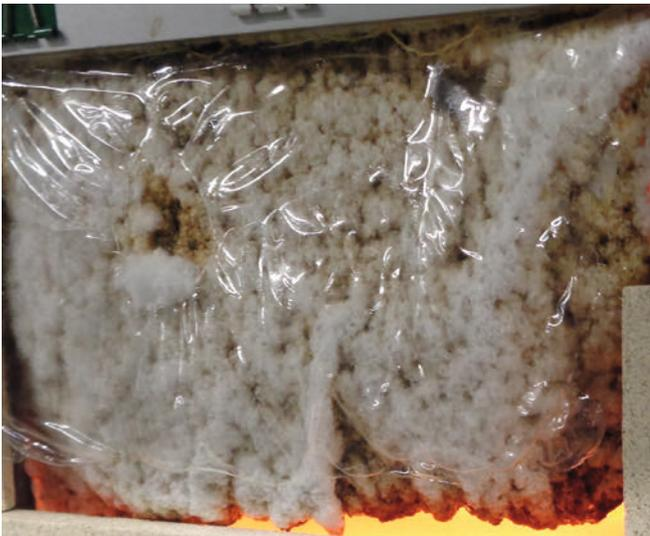
Abb. 1: Brandschutz-Folienlaminat im Kleinbrandversuch bei 500 °C.
