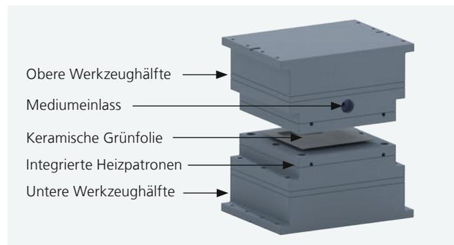
Abb. 4: Aufbau Werkzeug.
