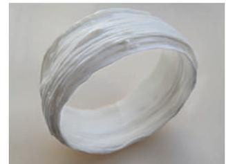
Abb. 2: Gewickelte Form mit Mikrokanalstruktur.
