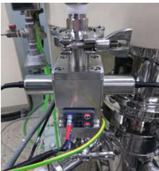
Abb 1: An einer Kugelmühle installierte Wirbelstrom- und Ultraschallsensoren.
