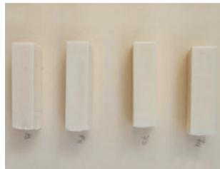
Abb. 1: Formteile mit Mikrokanalstruktur (Schlickerguss).
