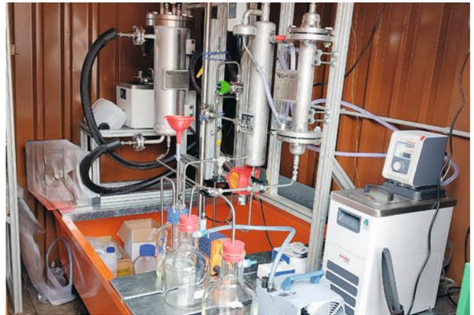
Abb. 2: Anlage zur Wasserabtrennung mittels hydrophiler Membran zur Ethanolabsolutierung.
