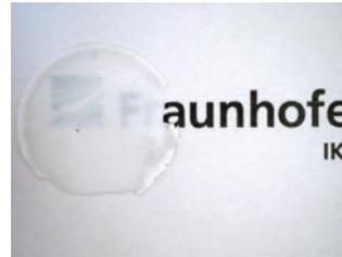
Abb. 1: Kaltgesintertes NASICON-Elektrolytsubstrat.
