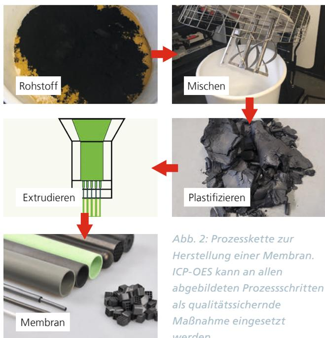
Abb. 2: Prozesskette zur Herstellung einer Membran. ICP-OES kann an allen abgebildeten Prozessschritten als qualitätssichernde Maßnahme eingesetzt werden.
