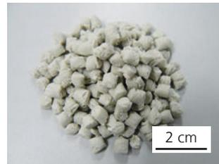
Abb. 1: Polymerkeramik-Spritzgießgranulat.
