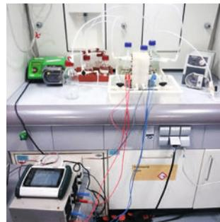
Abb. 2: Laborversuchsstand Totaloxidation.
