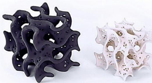
Abb. 1: TiO<sub>2</sub>-Komponente vor dem Entbindern (links) und nach dem Niedertemperatursintern bei 1000 °C (rechts).
