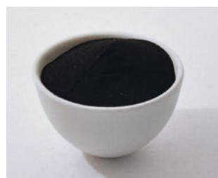
Abb. 3: Aus Biomasse thermisch hergestellter »Hard Carbon«.
