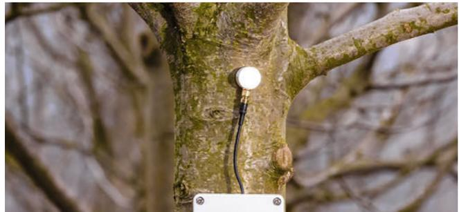
Abb. 1: Mit Kontaktmikrofon instrumentierter Obstbaum.
