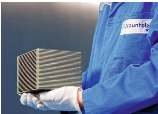
Abb. 1: Hochtemperatur-Elektrolyse-Stack für Wasserdampf- und Co-Elektrolyse (Betriebstemperatur 750 bis 830 °C).
