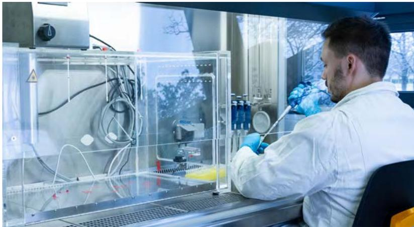
*Aufbau der Aerosoltestkammer zur definierten Untersuchung von luftgetragenen bakteriellen und viralen Erregern bis Sicherheitsstufe 2. Zusätzliche Geräte können integriert werden, um zielgerichtet Untersuchungen wie beispielsweise die Desinfektionseffizienz von UV-C-Strahlung bei luftgetragenen Erregern zu untersuchen.*
