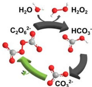
*Vorgeschlagener Reaktionsmechanismus der anodischen H<sub>2</sub>O<sub>2</sub>-Produktion in wässrigen Elektrolyten, die Carbonationen enthalten.*
