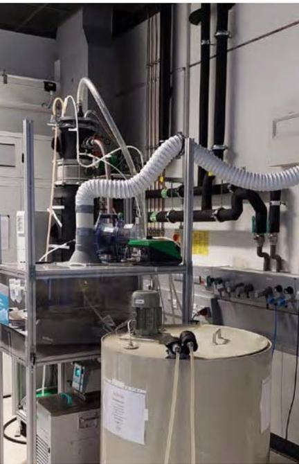
*Methanogene Stufe einer anaeroben Biogasanlage mit Festbett-Umlaufreaktor.*
