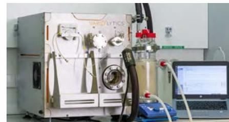
*In den Labors am Fraunhofer IGB konnte Variolytics die Messungen zur Validierung ihres preisgekrönten Emission Control Systems für Kläranlagen durchführen.*
