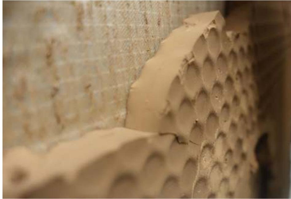
*Ligninabtrennung durch Filterpresse am Fraunhofer CBP*
