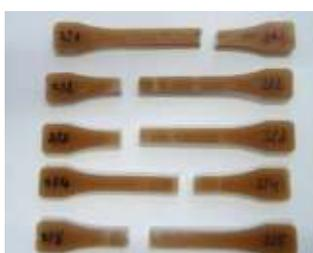
Hydrophobierte Cellulose im Tropfentest (oben links), Schnittfasern (Cordenka, oben rechts) und Bruchbild der Prüfstäbe 1BA (Faseranteil 10 %, links)
