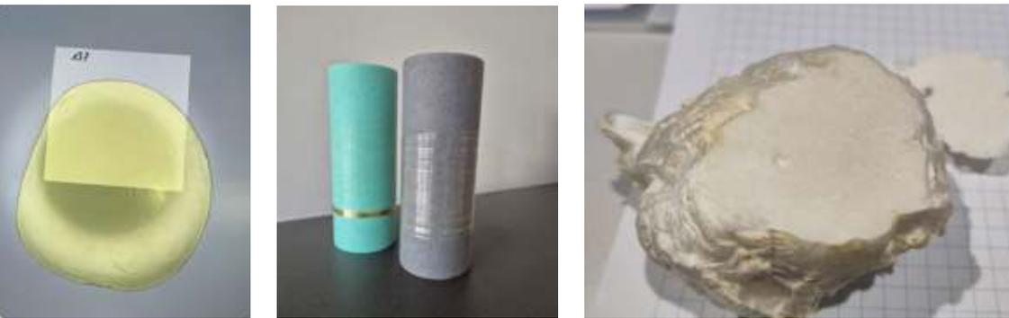
Weiterverarbeitung der Caramide zu Gusspolyamid-Platten (links), Fasern (Monofilamenten, Mitte) oder Schäumen (rechts) zur Demonstration verschiedener Anwendungen
