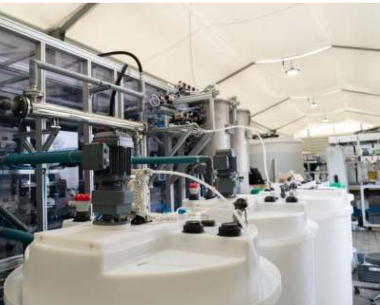
*Pilotanlage zur Rückgewinnung von Stickstoff aus Abwasser*
