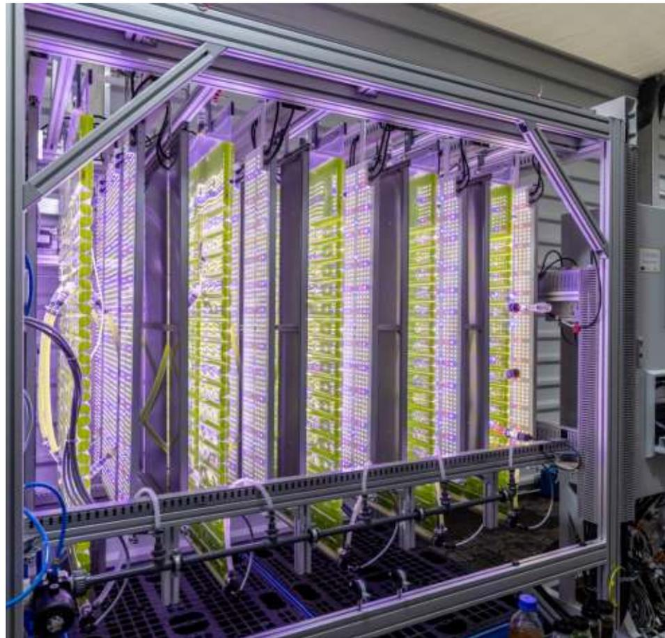
*Mikroalgen in einem neuartigen Photobioreaktorsystem binden  $\text{CO}_2$  und produzieren daraus eine pflanzenstärkende Biomasse.*
