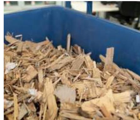
*Mit Holzschutzmitteln behandeltes Altholz muss derzeit in genehmigten Großkraftwerken verbrannt werden. In H<sub>2</sub>Wood entstehen daraus Wasserstoff, Carotinoide und Stärke.*
