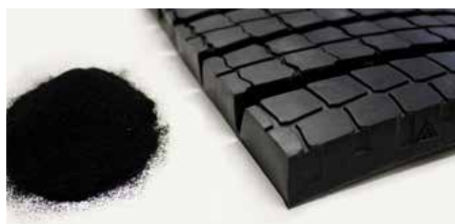
Beispiel unserer Kernkompetenz »Mikrostrukturdesign«: auf der Nanoskala optimierte Composite für geringeren Rollwiderstand von Reifen.
