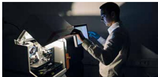
Unsere Fähigkeiten in der Geräteentwicklung zeigt beispielsweise das Gerät microPREP™, mit dem sich ultradünne Proben für die Nanoanalytik schneller und zuverlässiger herstellen lassen.
