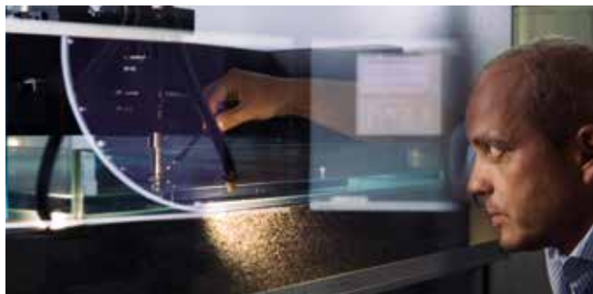
Mit akustischer Mikroskopie lassen sich kleinste Risse in Materialien erkennen, ohne die Proben zu zerstören.
