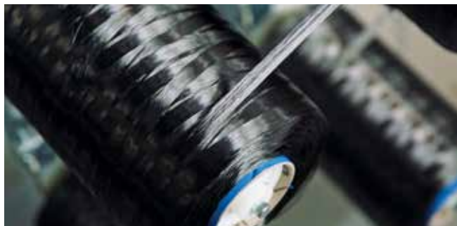
UD-Tapes aus faserverstärkten Kunststoffen werden zu besonders leichten und robusten Bauteilen verarbeitet.
