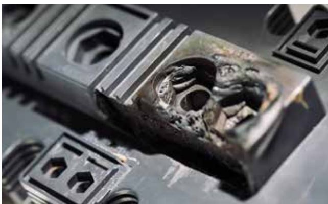
1 Kunststoffgehäuse eines Leistungsmoduls mit Materialschädigung (geschmolzenes Material) im Bereich der Lastanschlusslaschen.
