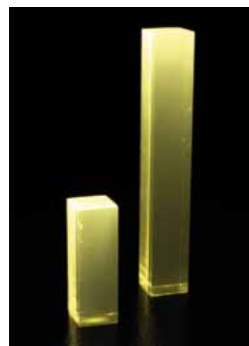
Dysprosium-dotiertes Boratglas als Lichtstab
