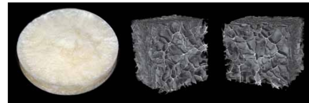
links: makroskopische Aufnahme eines runden Elastin/Gelatine-Schwammes (Halbzeug für eine Wundauflage) mit einem Durchmesser von 4 cm. Rechts daneben: (2 Würfel) sind Aufnahmen dieses Schwammes mittels Mikro-CT zu sehen, die die poröse Struktur dieses Schwammes zeigen. Die Kantenlänge des Würfels beträgt 5 mm.
