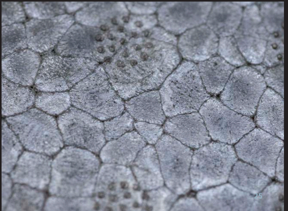
Gleichmäßige Porenstruktur eines induktiv geschäumten Polystyrols
